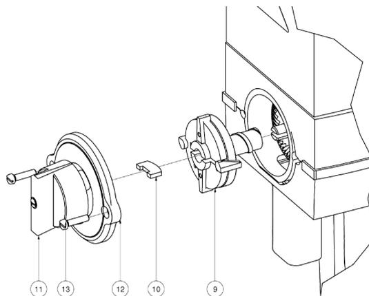
4. Ziehen Sie den Vorbrecher (9) von der Motorwelle ab. Benutzen Sie dazu eine Abziehvorrichtung (Artikel Nr. 4041).
